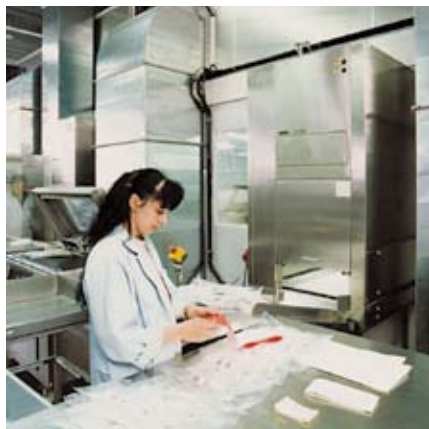
Sortie des produits emballés du sas de la salle blanche et envoi vers la stérilisation à l'extérieur.
