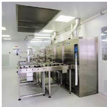
Entrée dans les sacs des produits finis et installation de lavage; Un filtre plafonnier recouvre la sortie.
