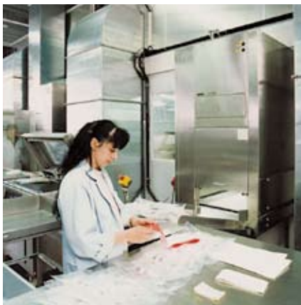
Ausschleusen der verpackten Teile aus dem Reinraum und Versand zur externen Sterilisation.
