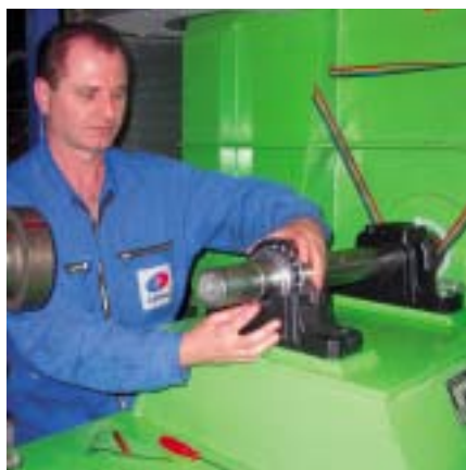
Einstellung eines Wellenlagers durch den Fachmann von Axima
